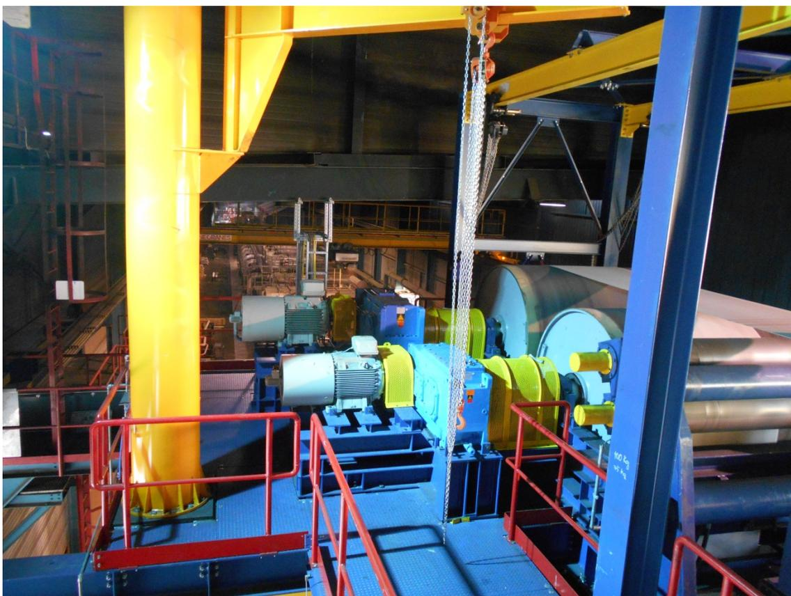
Modernisierter S-Rollen-Bereich der Glüh- und Beizlinie von Aperam im belgischen Genk, nach der Modernisierung durch Primetals Technologies
